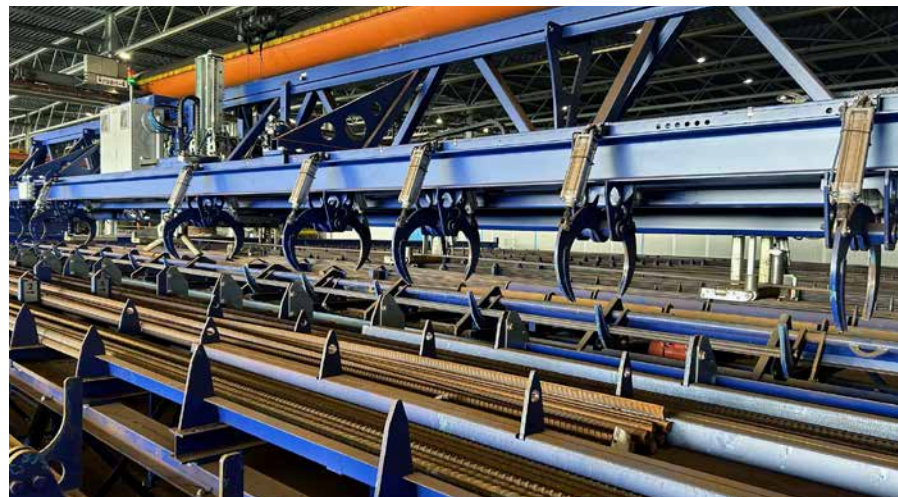
In de Schilt-productielijn worden wapeningsstaven met standaardlengtes automatisch geteld. Snel, efficiënt en nauwkeurig.
